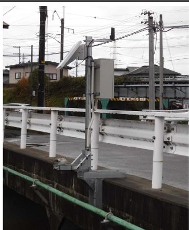
写真.1 水位計設置状況
