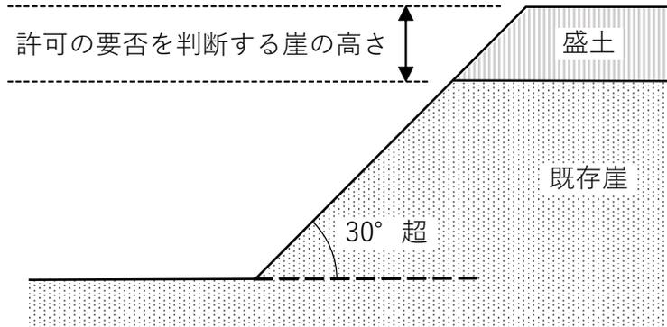
図1-7 崖の高さの判断イメージ図①
