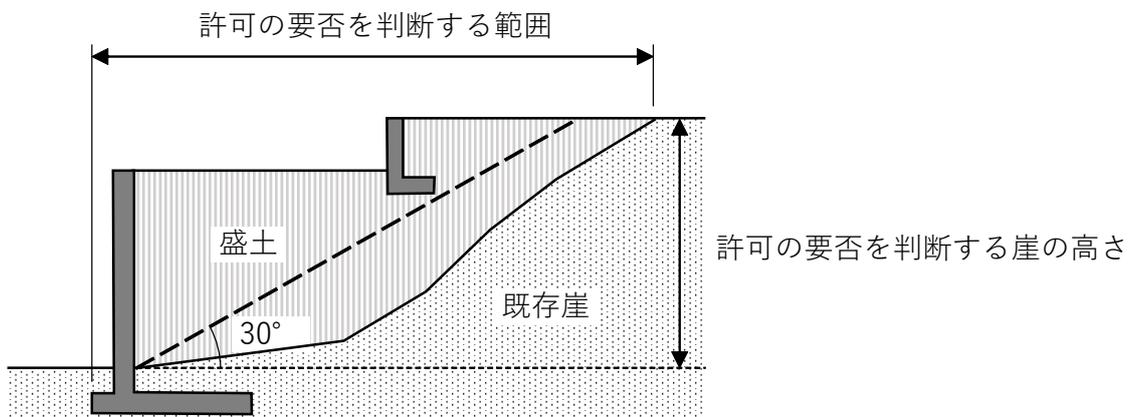
図1-9 崖の高さの判断イメージ図③
